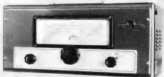
Bild 5. Ein ausschließlich mit Transistoren und Dioden bestückter kommerzieller Kurzwellenempfänger für den Bereich 1,9...15,7 MHz, aufgeteilt in drei Bänder, mit Bandspreizung (Radio Becker, Holland)
