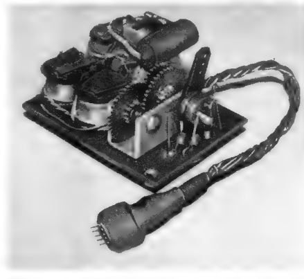
Bild 5. Der Höhenrudermotor. Man erkennt die Relais 3 und 4, das Getriebe 60 : 1, die Schaltlocke mit den Federn und dahinter den Elektromotor; Gewicht: 45 g
